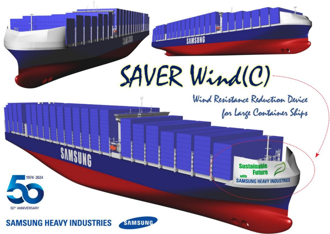
그림 2 삼성중공업이 개발한 대형 컨테이너선의 공기저항 저감 장치 SAVER Wind(C)
