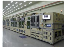
삼성디스플레이 홍승민 PL과 문홍주 프로, 에이치비솔루션 이상식 상무, 엔젯 성백훈 전무가 개발한 본 장비는 EHD 디스펜서를 이용하여 OLED 스마트폰 및 테블릿 제품의 카메라 홀과 테두리 부분의 빛샘/투습을 방지하고, 강도 개선을 위한 기능성 잉크를 정밀하게 도포하는 설비이다. 정밀한 위치에 도포하기 위해 패널 테두리를 인식하고 도포면의 높이를 측정하며, 도포 후 불량을 검출하기 위해 자동 검사를 수행한다.
