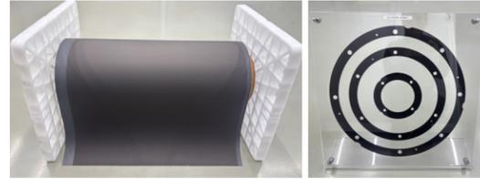
최현석 연구소장, 노치승 이사, 이종희 전임연구원이 개발한 TES-2500, 열 및 전기전도성 복합 개스킷(gasket)은 반도체 제조공정 중 반도체 칩의 수율과 품질 특성에 가장 큰 영향을 미치는 핵심 공정인 건식 에칭 공정의 드라이에처(dry etcher) 장비에 적용되는 기능성 개스킷 제품이다. 실리콘 웨이퍼(wafer)를 에칭하는 공정 중 발생하는 열을 방출하여 상부 전극의 기능을 안정적으로 유지시킨다.
